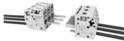
大电流穿墙端子，接线线径最大线径可达35mm<sup>2</sup>；模块化设计，接线位可扩展；螺钉接线使得传输更加稳定高效。
