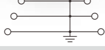
2.5mm 2 三层等电位接地端子 Triple Level With Equipotential Bond Ground Terminal Block
