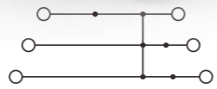
2.5mm² 三层等电位接线端子 Triple Level With Equipotential Bond Terminal Block
